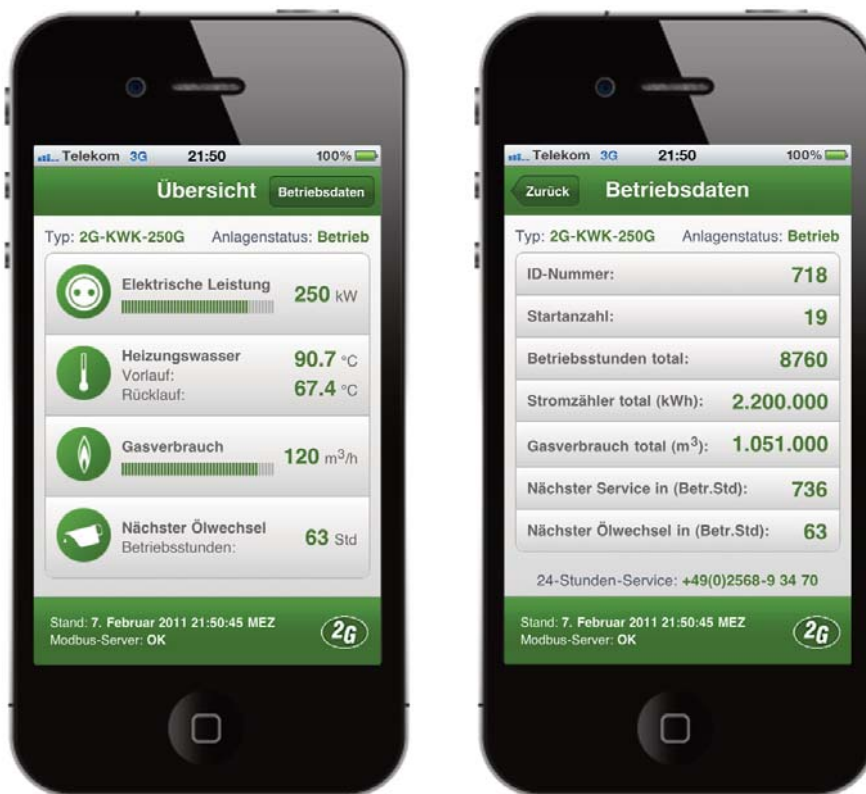
Bild 3: Die webbasierte Visualisierung der Anlagendaten.
