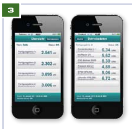
Bild 3. Der Energiebedarf einzelner Fertigungslinien sowie die aktuellen Verbrauchsdaten ausgewählter Messpunkte lassen sich in Echtzeit auf dem Smartphone betrachten
