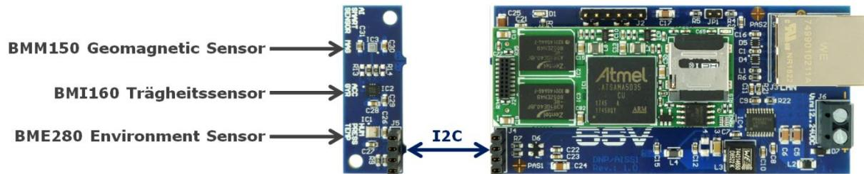
**Abbildung:** Der bei Bedarf abtrennbarer Sensorkopf des DNP/AIIS1 besitzt drei Bosch-Sensoren mit verschiedenen Sensorelementen: 1x BMM150 Geomagnetischer Sensor, 1x BMI160 6-Achsen Inertial Measurement Unit (Trägheitssensor mit jeweils zwei triaxialen Sensorelementen) sowie 1x BME280 Environment Sensor mit drei Sensorelementen für Temperatur, Luftdruck und rel. Luftfeuchte.
