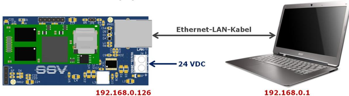
**Abbildung:** Der Ethernet-LAN-Port des DNP/AIIS1 besitzt ab Werk die IP-Adressen 192.168.0.126. Ihr PC sollte die statische IP-Adresse 192.168.0.1 benutzen. Verkabeln Sie die Systeme wie in der Abbildung dargestellt. Verwenden Sie bitte das LAN-Kabel und das 12 bzw. 24 VDC-Steckernetzteil aus dem Lieferumfang des Starterkits.
